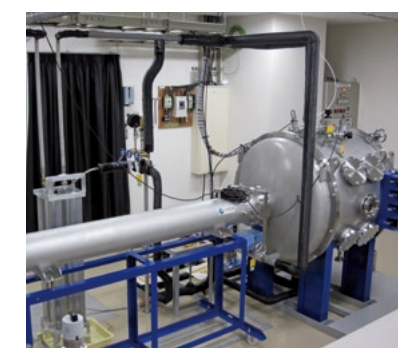
火星探査試験用スペースチェンバー 本体寸法:φ1.0m×0.8m 到達圧力:133Pa Space chamber for testing Mars exploration Chamber Body: Diameter 1.0m x 0.8m Ultimate Pressure: 133Pa
