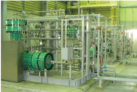
水素ガス圧縮機 処理量: 200Nm³/h, 300Nm³/h, 500Nm³/h Hydrogen gas compressor Processing Capacity: 200Nm³/h, 300Nm³/h and 500Nm³/h
