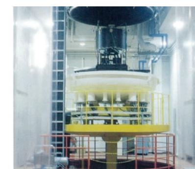
宇宙環境試験装置 人工衛星・衛星探査機などの環境試験用スペースチェンバー 本体寸法:φ4.0m×6.8m 到達圧力:1.33×10 -5 Pa System for testing space environment A space chamber for testing environments of a satellite, satellite probe and other equipment Chamber Body: Diameter 4.0m x 6.8m Ultimate Pressure: 1.33 x 10 -5 Pa
