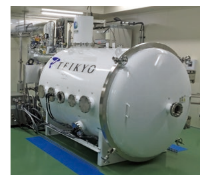
小型衛星を試験するスペースチェンバー 本体寸法:内径 φ1.5m×1.8m 到達圧力:5.0×10 -5 Pa Space chamber for testing small satellite The largest space simulation Chamber Body: Inside diameter 1.5m x 1.8m Ultimate Pressure: 5.0 x 10 -5 Pa
