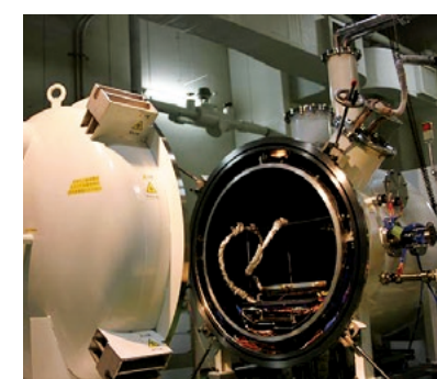
内惑星熱真空環境シミュレーター 本体寸法:φ1.2m×1.0m 到達圧力:5.0×10 -5 Pa Interior planet thermal-vacuum environment simulator Simulator Body: Diameter 1.2m x 1.0m Ultimate Pressure: 5.0 x 10 -5 Pa
