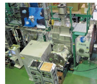
電気推進耐久試験装置 小惑星探査機「はやぶさ」の試験に使われた中型チェンバー 本体寸法:内径 φ2.0m×5.2m 到達圧力:4.0×10 -4 Pa Endurance test system for electrical propulsion Medium-size chamber used in testing the compact Asteroid Explorer Hayabusa Chamber Body: Inside diameter 2.0m x 5.2m Ultimate Pressure: 4.0 x 10 -4 Pa
